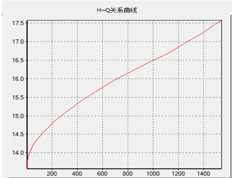
图 4-18 墩仔大坑河口处断面水位流量关系曲线图
